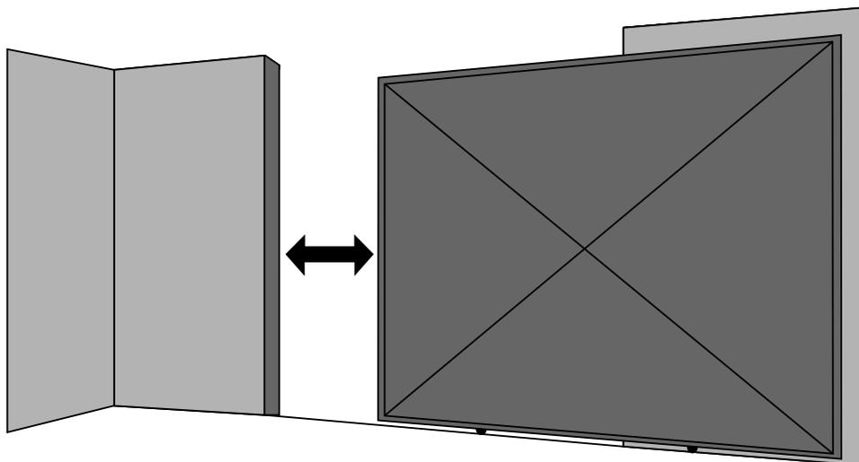
2º Para a instalação do movimentador deslizante é necessário uma base de concreto ou uma base metálica para a fixação do mesmo. A base deve ter uma medida mínima conforme mostra a imagem. É importante que a base fique com sua superfície na mesma altura dos trilhos e aproximadamente 25 mm de distância da folha do portão.
