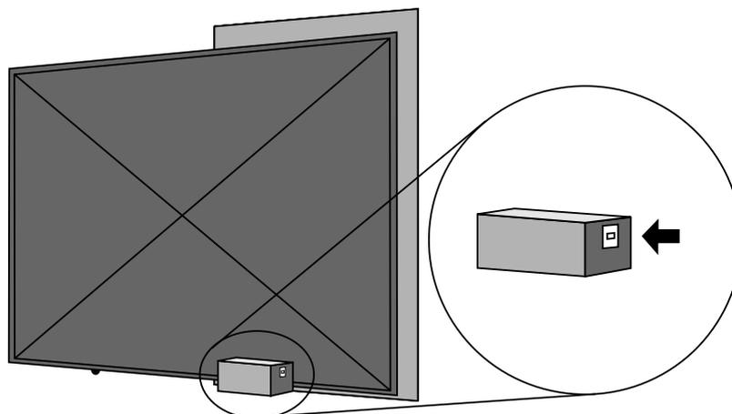
4º Conforme a base foi feita, posicione o movimentador em cima da mesma com o lado da engrenagem virado para a folha do portão, conforme imagem abaixo. Marque os quatro furos conforme as furações da base do movimentador e faça os furos de acordo com a medida dos parafusos que acompanham o kit do movimentador. Com as furações feitas, coloque as quatro buchas que acompanham o kit, posicione o movimentador em cima das furações realizadas e aperte os parafusos.
