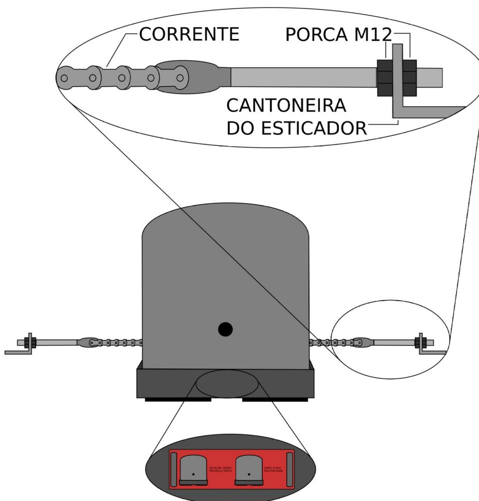
**Obs.:** Cole o adesivo do Sistema de destravamento na base plástica do movimentador, como mostra a imagem. Antes de aplicar, limpe a superfície com álcool isopropílico.
