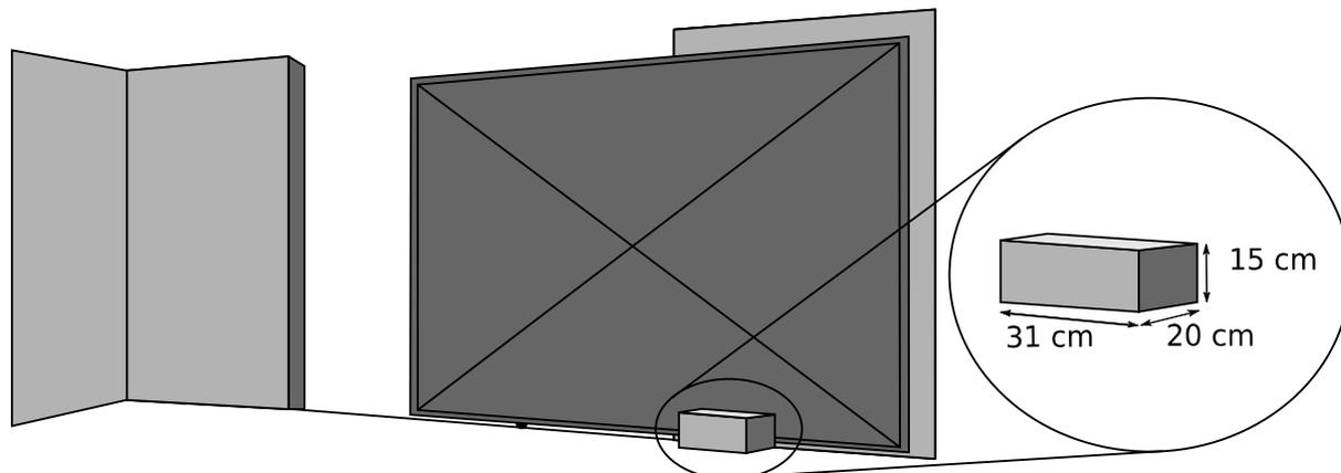
3º Providencie um ponto de energia interrompido por um disjuntor de 10A próximo de onde o movimentador será instalado.
