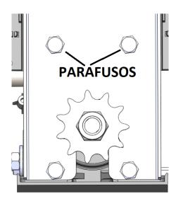
8º Após a fixação, remova o esticador para colocar a corrente (o ajuste será executado posteriormente).
