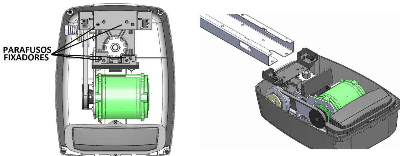
6º Após a calha de encaixe estar na posição correta, coloque os parafusos fixadores.
