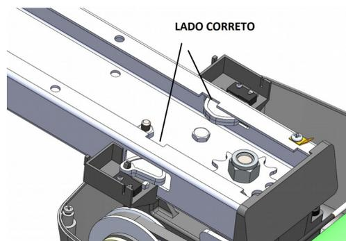
9º Após a fixação dos acionadores, remova o esticador para colocar a corrente (o ajuste será executado posteriormente).
