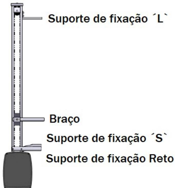
11° Após o movimentador estar alinhada (totalmente), solde os suportes de fixação na coluna do portão e na parte superior da coluna, o cavalete na medida apresentada no passo 3 e o braço no pino do cavalete.
