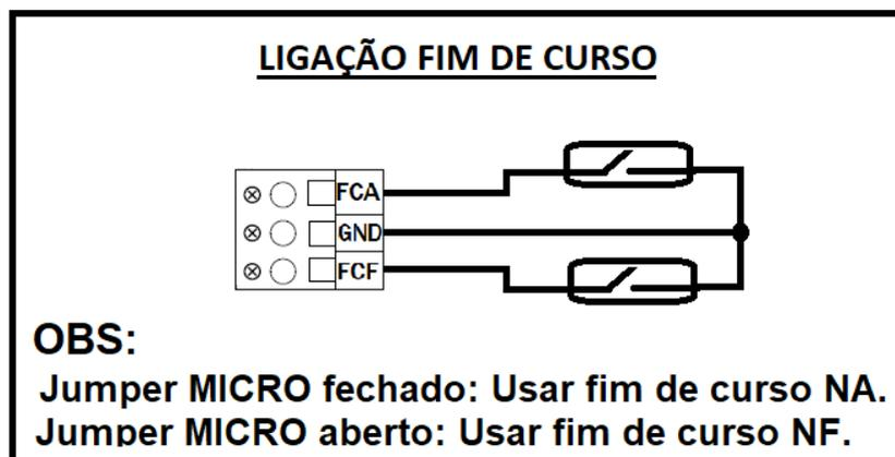
Caso os leds estejam acesos simultaneamente a Placa de Comando não funcionará. Verifique o JUMPER MICROS.
