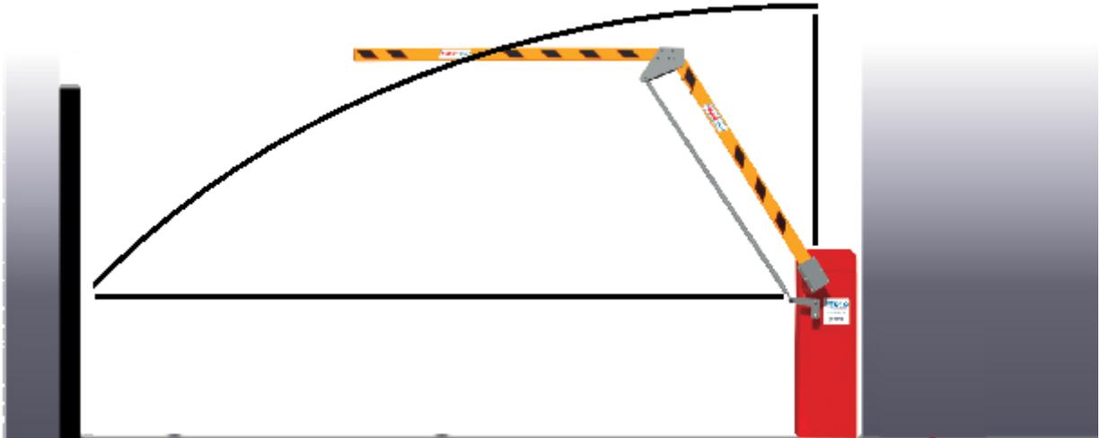
2º Providencie um ponto de energia interrompido por um disjuntor de 10A próximo de onde a cancela será instalada.
