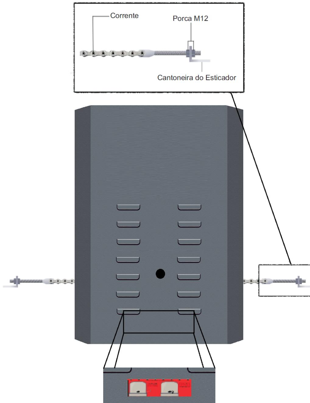
**Obs.:** Cole o adesivo do Sistema de destravamento na base do movimentador, como mostra a imagem. Antes de aplicar, limpe a superfície com álcool isopropílico.
