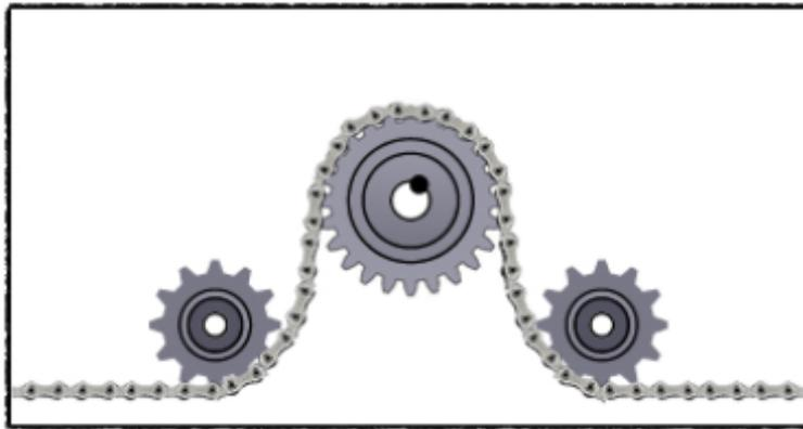
6º Após o movimentador estar devidamente preso e alinhado solde os dois esticadores que se encontram nas extremidades e tencione a corrente.
