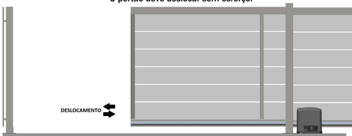
8º Utilizando o kit de instalação (Kit ímã e parafuso) fixe o kit Ímã na cremalheira observando sua posição operacional, ou seja, nas extremidades. Os kit's ímã devem estar em posições em que a folha do portão abranja a posição totalmente aberta ou fechada. Para a movimentação da folha do portão completa será necessário destravar o movimentador conforme imagem presente no 7º ponto.
