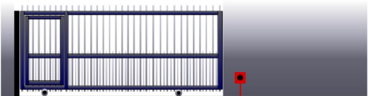
3º Para a instalação do movimentador deslizante é necessário uma base de concreto ou uma base metálica para a fixação do mesmo. A base deve ter uma medida mínima conforme mostra a imagem. É importante que a base fique com sua superfície na mesma altura dos trilhos e aproximadamente 25 mm de distância da folha do portão.
