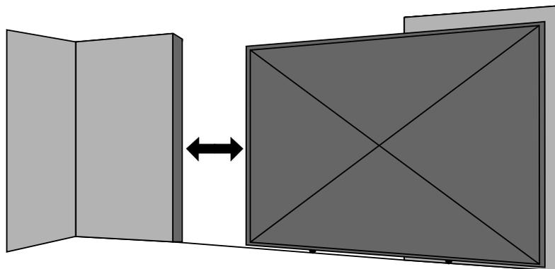
2º Para a instalação do movimentador deslizante é necessário uma base de concreto ou uma base metálica para a fixação do mesmo. A base deve ter uma medida mínima conforme mostra a imagem. É importante que a base fique com sua superfície na mesma altura dos trilhos e aproximadamente 25 mm de distância da folha do portão.
