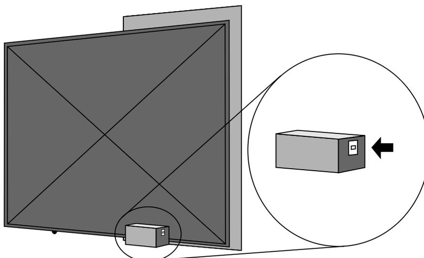
4º Conforme a base foi feita, posicione o movimentador em cima da mesma com o lado da engrenagem virado para a folha do portão, conforme imagem abaixo. Marque os quatro furos conforme as furações da base do movimentador e faça os furos de acordo com a medida dos parafusos que acompanham o kit do movimentador. Com as furações feitas, coloque as quatro buchas que acompanham o kit, posicione o movimentador em cima das furações realizadas e aperte os parafusos.
