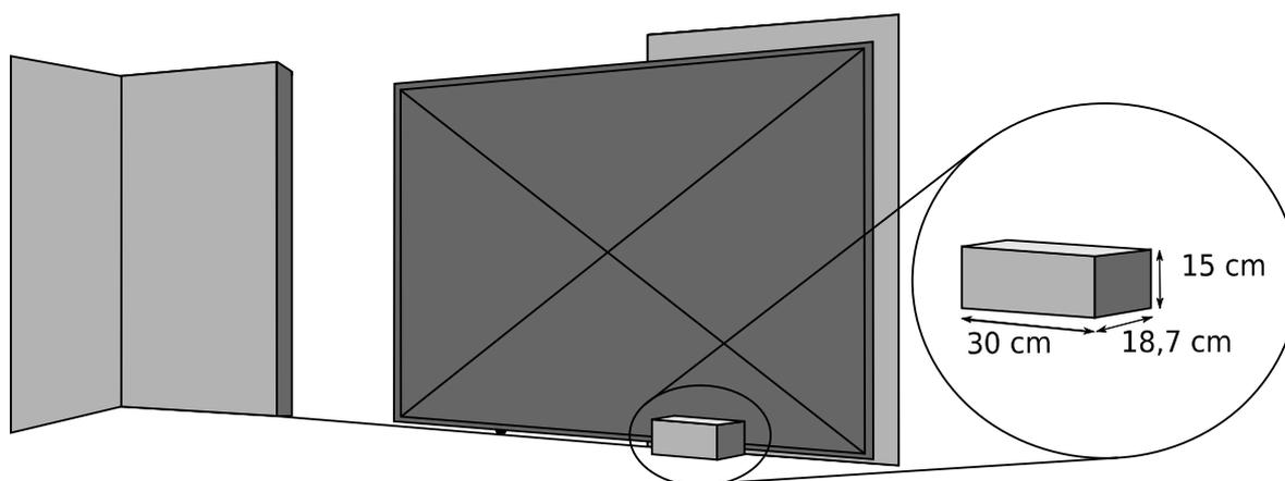
3º Providencie um ponto de energia interrompido por um disjuntor de 10A próximo de onde o movimentador será instalado.
